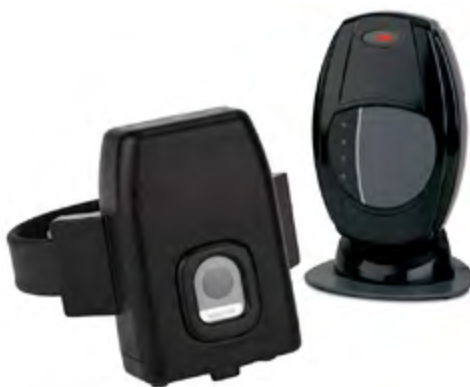
2. számú ábra: 3M ITrack nyomkövető (balra) és beacon (jobbra) egység
